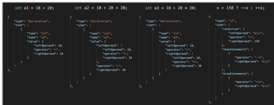
图 4 简单逻辑的代码与 DSL 示例
