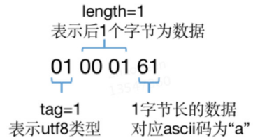
图7 CONSTANT_utf8_info 的结构(左)及示例(右)
